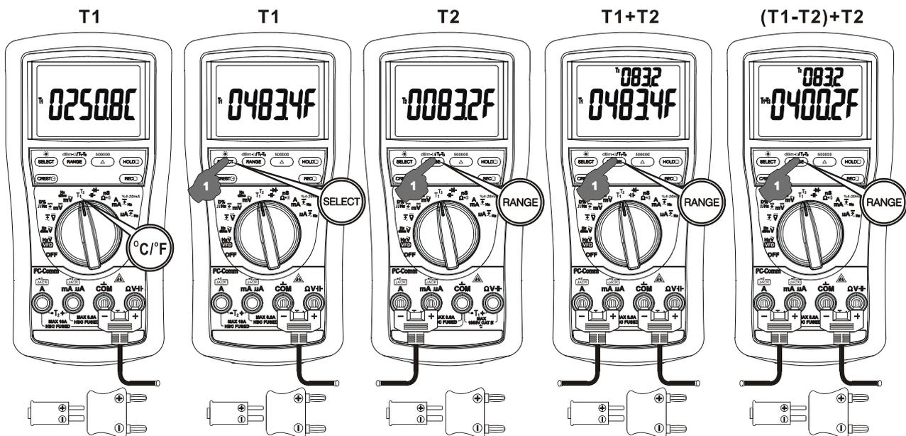
Hinweis: Stellen Sie sicher, dass der Bananenstecker des Temperaturfühlers AMD 9023 Typ K mit der richtigen **+ -** Polarität angeschlossen ist. Sie können zudem den
