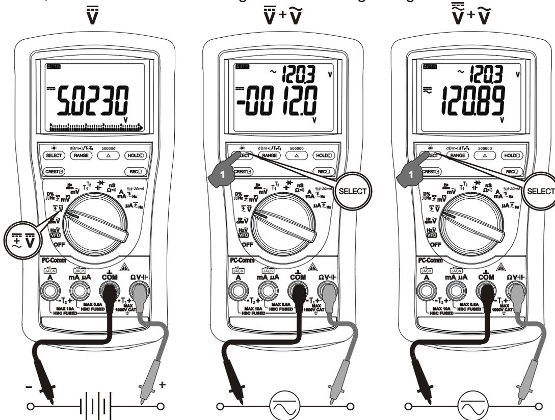
**DCmV<sup>-</sup>, DCmV<sup>+</sup> + ACmV<sup>-</sup>, DC + ACmV<sup>+</sup> + ACmV<sup>-</sup>, Logikpegel  $\square$  Hz- und Duty%-Funktionen**
