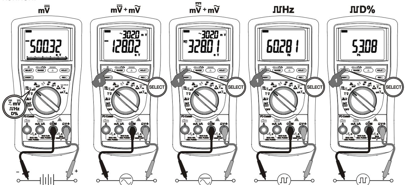
**ACmV<sup>+Hz-</sup>, dBm<sup>+Hz-</sup>, Hz<sup>+ACmV-</sup>-Funktionen**
